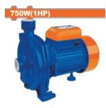
Bomba centrífuga Voltaje: 220-240V~50Hz Potencia nominal: 750 W (1,0 HP) Cabeza máxima: 28 m Flujo máximo: 100 l/min Succión máxima: 8m Diámetro de la tubería: 1"x1" Motor de alambre de aluminio Impulsor de acero inoxidable Cable de 0,3 m de longitud Embalado en caja de cartón
